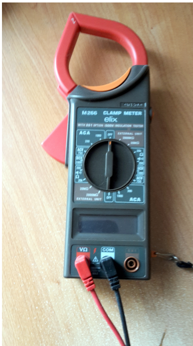
FIGURE 2.2 – Pince ampèremétrique. Par Pano38 — Travail personnel, CC BY-SA 4.0, https://commons.wikimedia.org/w/index.php?curid=47203181
