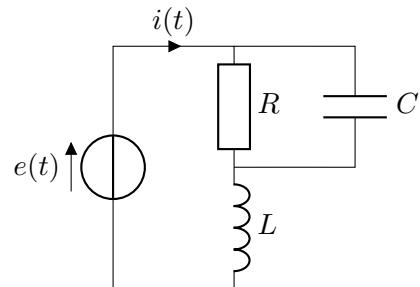
Le circuit est alimenté par une tension sinusoïdale  $e(t) = E \cos(\omega t)$ . On se place en régime sinusoïdal établi.
