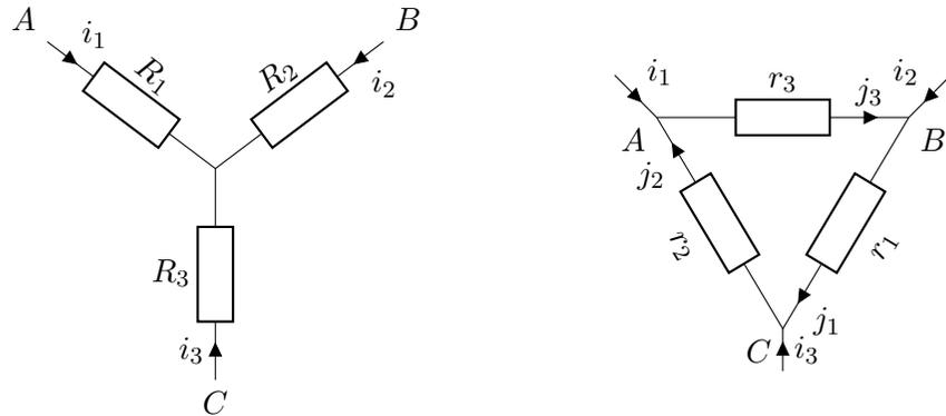
1. Exprimer la différence de potentiel  $U_{AB}$  pour les deux montages en fonction des courants  $i_1$  et  $i_2$  pour l'un et de  $j_3$  pour l'autre.
