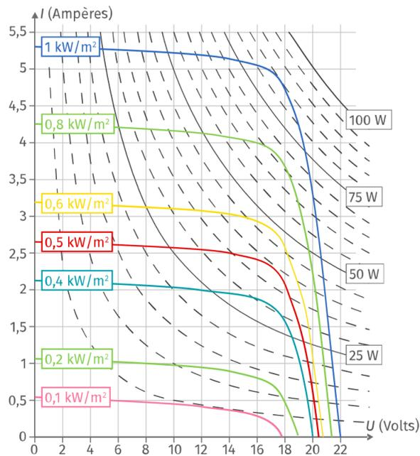
1. Quelle est la tension aux bornes du panneau pour un éclairement de  $600 \text{ W} \cdot \text{m}^{-2}$  et une intensité débitée égale à  $3 \text{ A}$  ?
