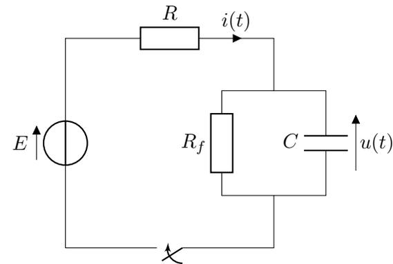
1. Déterminer les expressions, en régime permanent, de la tension  $u_\infty$  aux bornes du condensateur et de l'intensité  $i_\infty$ .
