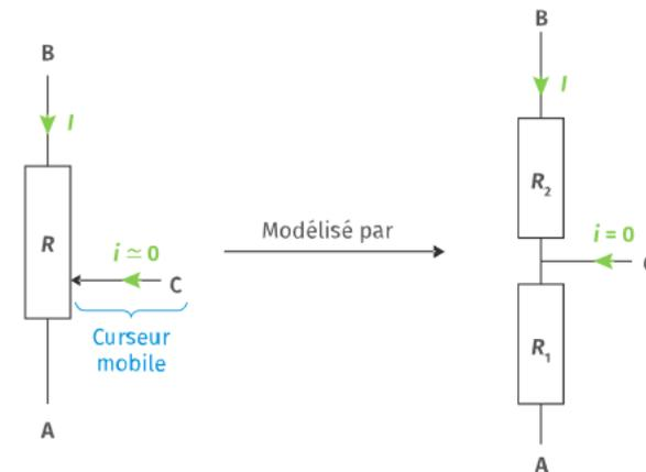
1. Par la loi d'additivité des tensions et la loi d'Ohm, exprimer  $U_{BA}$  en fonction de  $R_1$ ,  $R_2$  et  $I$ .
