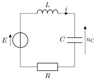
FIGURE 4.2 – Circuit  $RLC$  pour  $t \geq 0$ .
