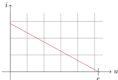
FIGURE 1.8 – Caractéristique d'une source de tension réelle.
