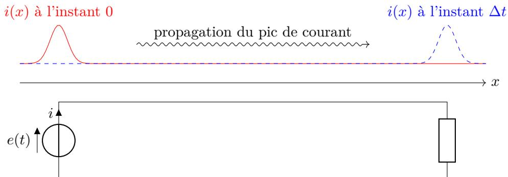
FIGURE 2.2 – Propagation d'un pic de courant  $i(x, t)$  d'une source de tension vers un résistor.
