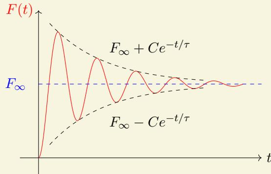
$\Omega = \omega_0 \times \sqrt{1 - \frac{1}{4Q^2}}$  est la pulsation des oscillations du système, qui toujours inférieure à  $\omega_0$ . Un système oscillera d'autant plus lentement qu'il est amorti.
