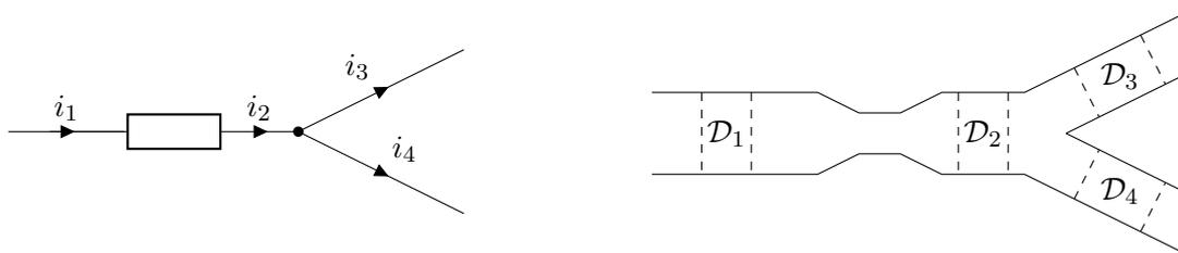
FIGURE 1.2 – Analogie hydro-électrique : les courants  $i$  deviennent des débits  $\mathcal{D}$ .
