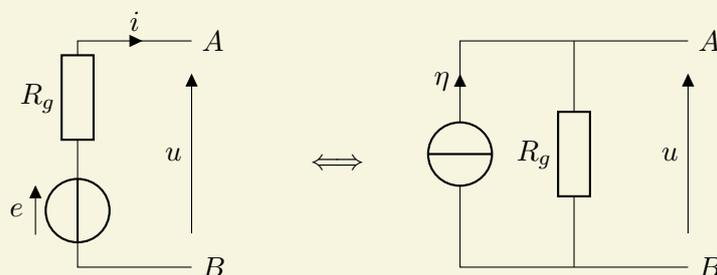
Ainsi, une source réelle de tension, qui est constituée d'une source idéale de tension et d'une résistance en série, est équivalente à une source réelle de courant, qui est constituée d'une source idéale de courant et d'une résistance en dérivation.
