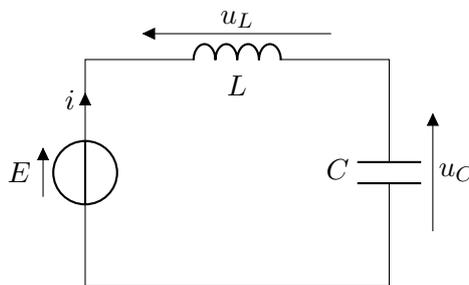
FIGURE 4.1 – Circuit LC pour  $t \geq 0$ .
