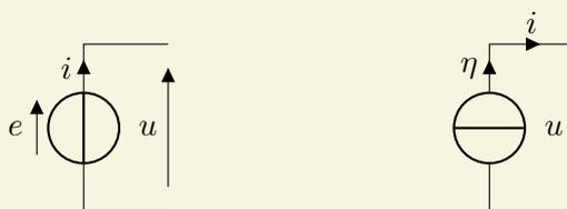
Une **source idéale de tension** (gauche) délivre la tension  $u = e$  quel que soit le courant  $i$  la traversant.  $e$  est alors appelée la force électromotrice (ou fém).
