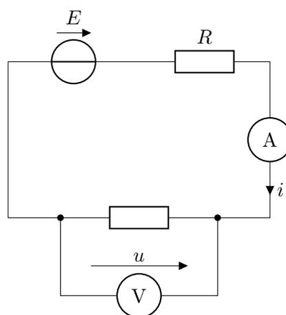
FIGURE 1.6 – Mesure de la caractéristique d’un dipôle.
