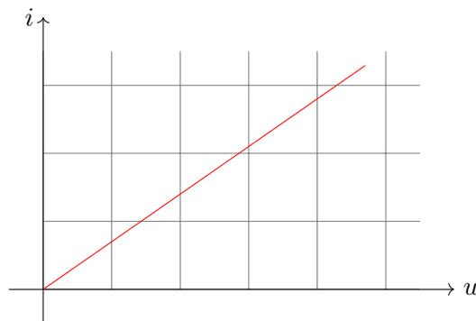
FIGURE 1.7 – Caractéristique d'un résistor.
