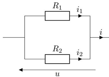
FIGURE 2.7 – Deux résistors en parallèle.
