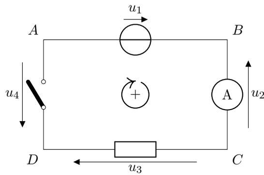
FIGURE 1.5 – Exemple de circuit électrique. Le symbole au centre du circuit explique dans quel sens on « décompte » les tensions électriques : positivement pour celles qui sont orientées dans le sens des aiguilles d’une montre, et négativement pour celles qui sont orientées dans l’autre sens.
