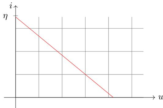
FIGURE 1.9 – Caractéristique d'une source de courant réelle.
