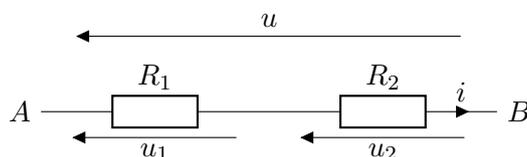
FIGURE 2.6 – Deux résistors en série.
