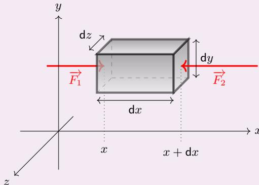
Puisque la face de gauche a une surface  $dydz$  et est contenue à l'abscisse  $x$ , on en déduit que  $\delta\vec{F}_1 = p(x, y, z) \times dydz \cdot \vec{u}_x$ .
