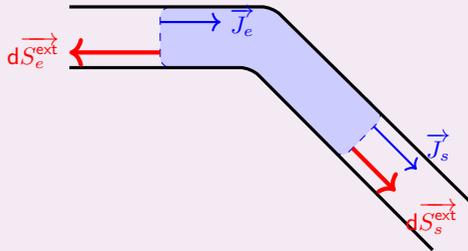
En régime permanent,  $\Sigma$  possède une masse constante. En notant  $\delta M_e = \mathcal{D}_m^{\text{entrant}} \times dt$  la masse entrant pendant  $dt$  et  $\delta M_s = \mathcal{D}_m^{\text{sortant}} \times dt$  la masse sortant pendant  $dt$ , on a donc  $\delta M_e = \delta M_s$ , c'est-à-dire :  $\mathcal{D}_m^{\text{entrant}} = \mathcal{D}_m^{\text{sortant}}$ .
