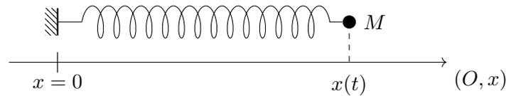
Initialement, le ressort a une longueur  $\ell_0 + L$  et est lâché sans aucune vitesse. Des frottements fluides ralentissent continuellement le point  $M$  : leur puissance est  $\mathcal{P}_f = -\lambda \dot{x}^2$  avec  $\lambda = 4 \text{ kg} \cdot \text{s}^{-1}$ . On donne par ailleurs le résultat numérique suivant :  $16 - 80 = -64 = -8^2$ .
