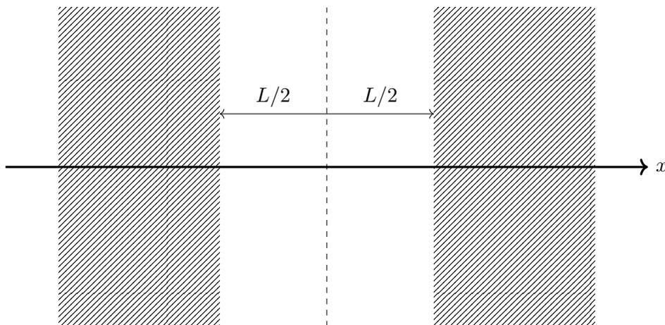
FIGURE 6.2 – Cavité entre deux conducteurs parfaits.
