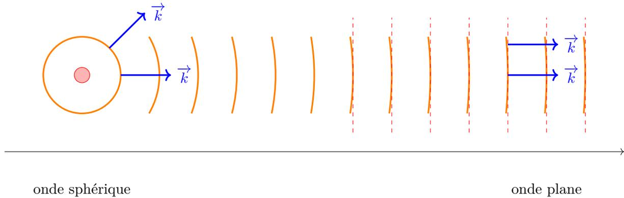
FIGURE 3.1 – De l'onde sphérique à l'onde plane.
