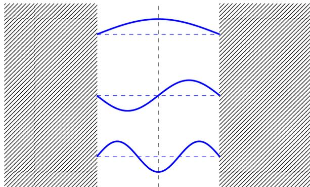
FIGURE 6.3 – Modes propres du champ électrique pour la cavité (de  $m = 1$  à  $m = 3$ ).
