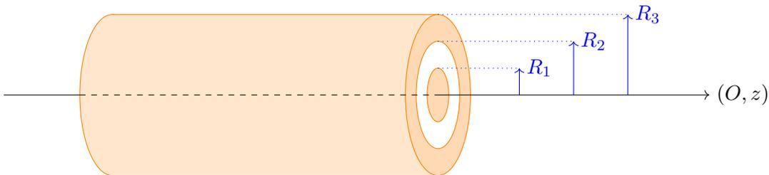
Le conducteur central (« l'âme ») est parcouru par un courant total  $I$  orienté dans le même sens que l'axe  $(O, z)$ . Le conducteur externe est parcouru par un courant total  $I$  orienté dans le sens opposé à l'axe  $(O, z)$ .
