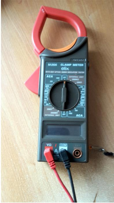
La pince ampèremétrique, aussi appelée capteur de courant sans contact, est un type d'ampèremètre permettant de mesurer l'intensité du courant électrique circulant dans un fil conducteur sans avoir à ouvrir le circuit pour y placer un ampèremètre classique (voir figure 4.1).
