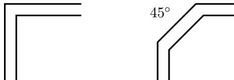
La section de la canalisation cylindrique est de rayon  $R = 3 \text{ cm}$  constant, le fluide transporté est de l'eau. On a  $L = 1 \text{ m}$ .
