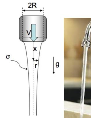
Un filet d'eau, de vitesse initiale  $V$ , coule verticalement vers le bas. On note  $R$  le rayon du robinet; l'axe  $(O, x)$  est orienté vers le bas.
