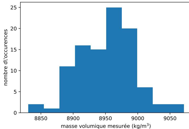
FIGURE 2 – Histogramme montrant la répartition des masses volumiques pour 100 échantillons.
