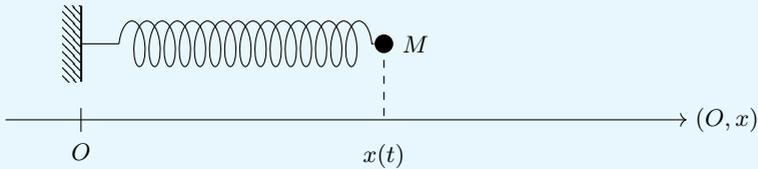
Des frottements fluides  $\vec{f} = -\lambda \cdot \vec{v}(M)$  ralentissent le point  $M$ , qui est également excité par une force extérieure  $\vec{F} = F_0 \cos(\omega t) \cdot \vec{e}_x$ . La pesanteur est négligée, ainsi que toute réaction du support.
