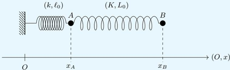
On néglige la pesanteur et la réaction du support, et on admet qu'une force de frottements fluides  $\vec{f} = -\lambda \cdot \vec{v}(B)$  s'applique uniquement sur le point  $B$ . Déterminer deux équations différentielles couplées portant sur  $x_A$  et  $x_B$ .
