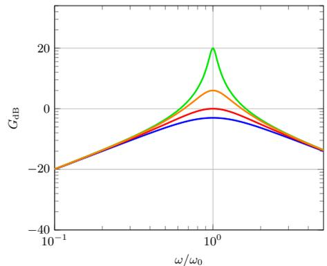
Phénomène de résonance en position sur un diagramme fréquentiel d'un filtre passe-bas d'ordre 2. Bleu :  $Q = 1/\sqrt{2} \approx 0,707$  ; rouge :  $Q = 1$  ; orange :  $Q = 2$  ; vert :  $Q = 10$ .
