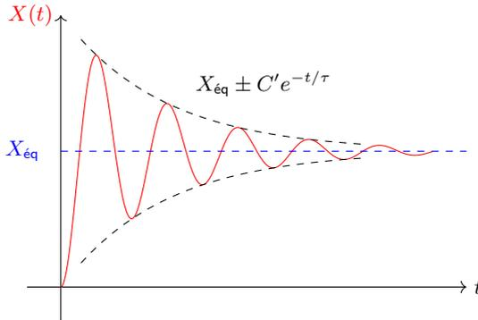
♥  $\Omega = \omega_0 \times \sqrt{1 - \frac{1}{4Q^2}}$  n'est pas égal à  $\omega_0$ , sauf quand  $Q$  tend vers l'infini. Un système oscillera donc d'autant plus lentement qu'il est amorti.
