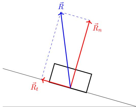
FIGURE 1 – Composantes de la force de réaction du support.
